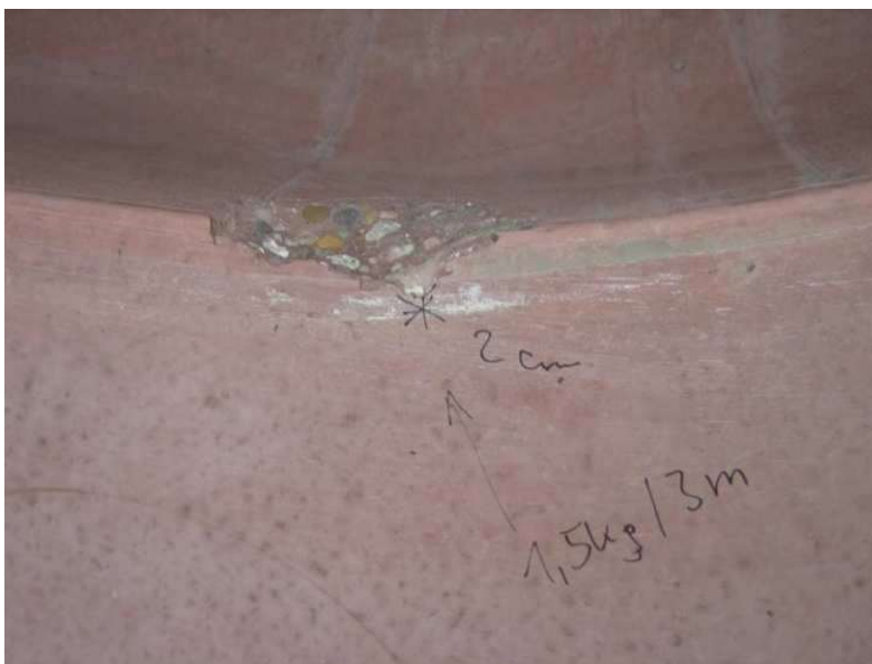
Immagine 24: pozzetto in calcestruzzo SCC ad alta prestazione – 1,5 kg da 3,0 m
