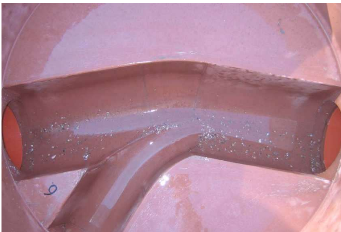
Immagine 42: pozzetto in CLS - SCC ad ALTA PRESTAZIONE DN 250 dopo 50 passaggi
