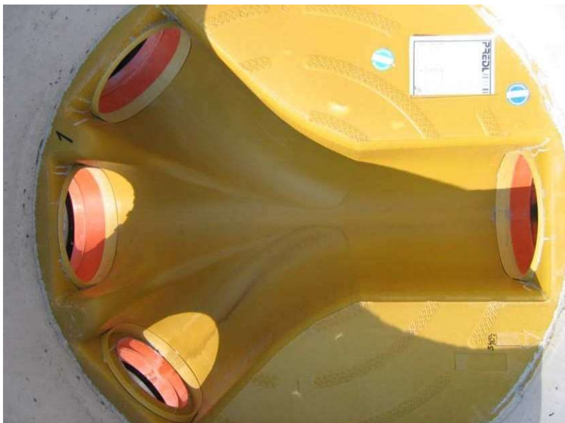
Immagine 1: campione di prova 1 / base pozzetto in polipropilene termoformato con manicotti a tenuta
