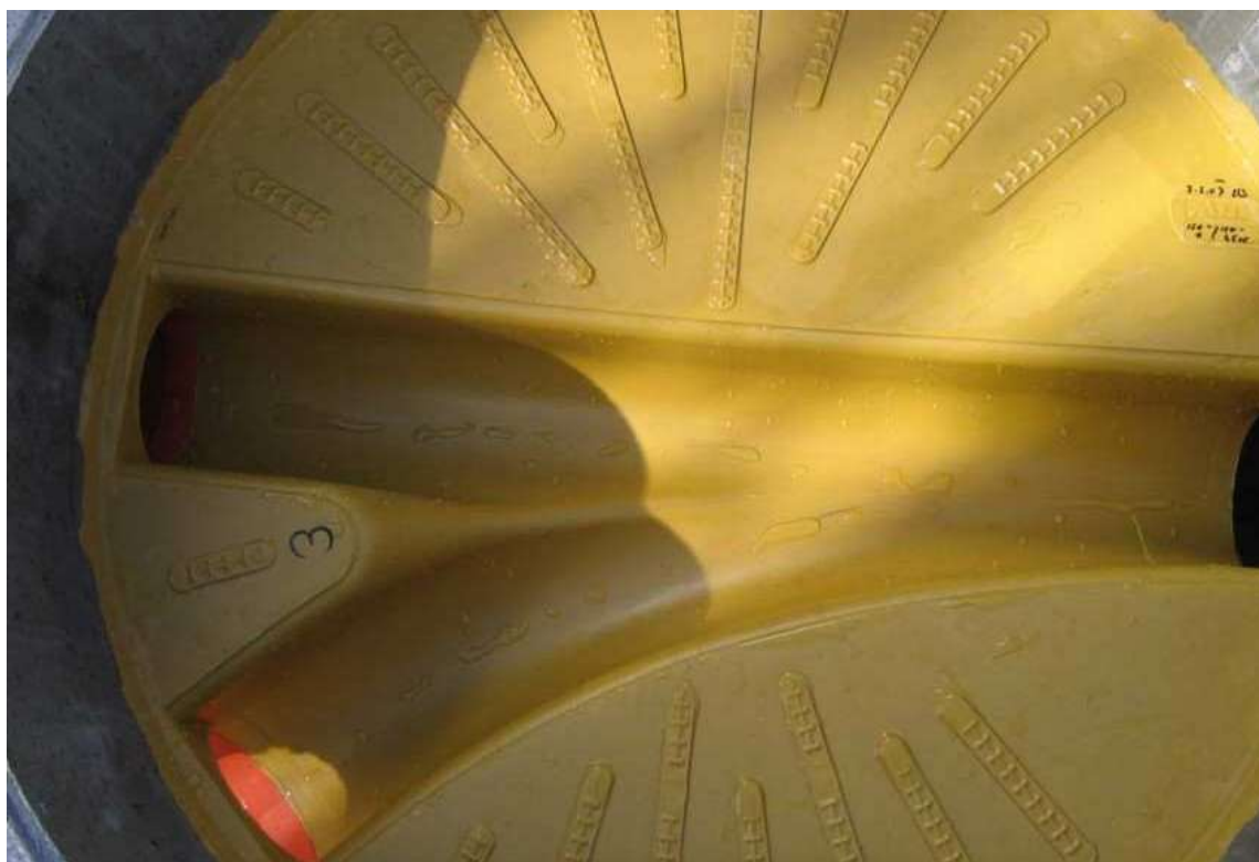
Immagine 35: pozzetto in PP - polipropilene dopo 50 passaggi
