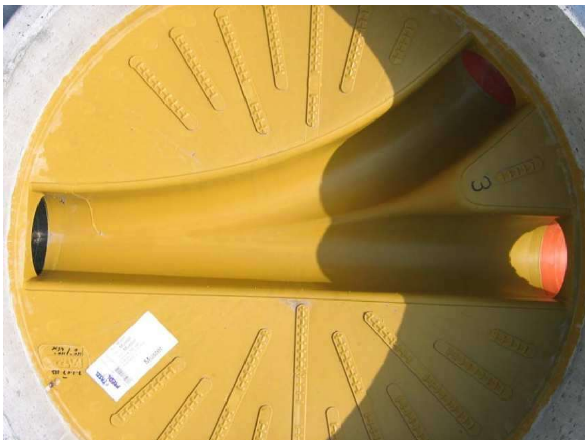
Immagine 3: campione di prova 3 / base pozzetto in polipropilene termoformato con manicotti a tenuta
