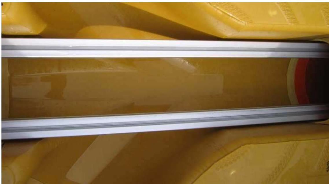
Immagine 6: pozzetto in PP - polipropilene dopo 50 lavaggi
