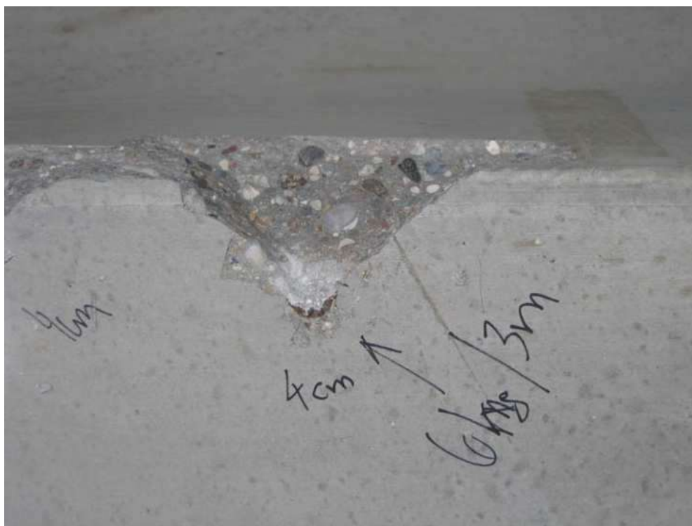
Immagine 21: pozzetto in calcestruzzo - 6 kg da 3,0 m
