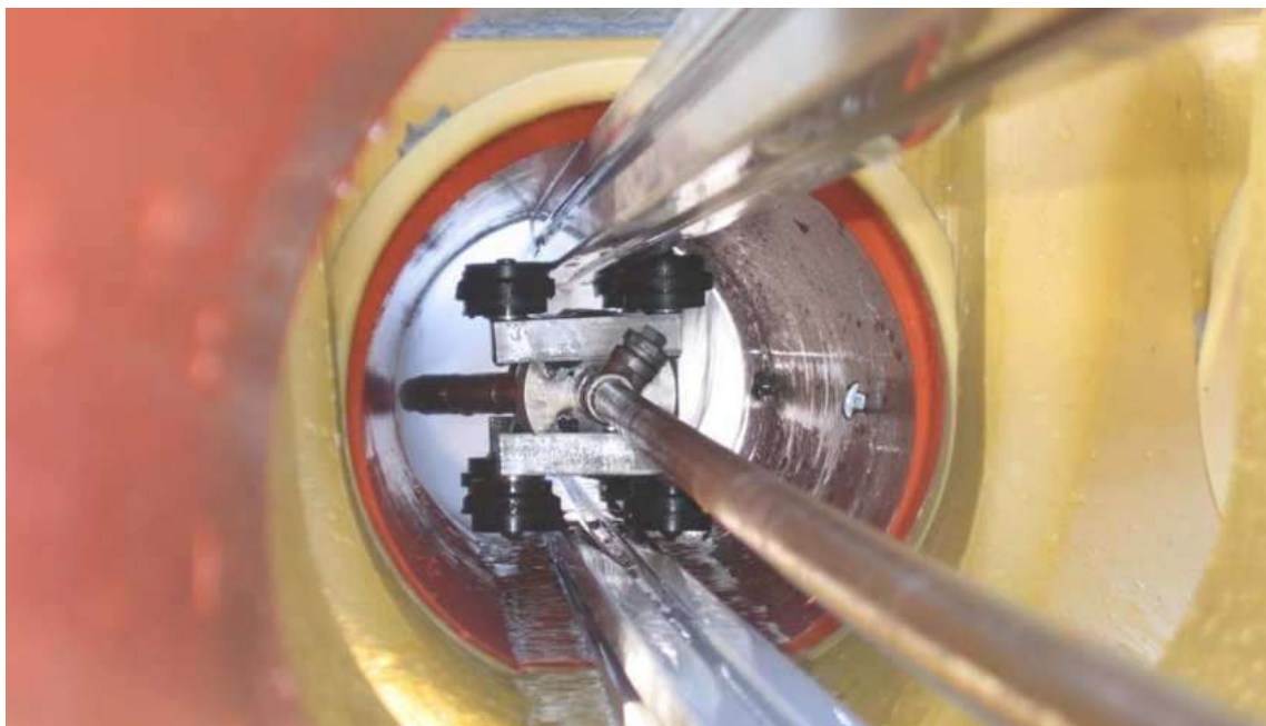
Immagine 5: disposizione carello per il lavaggio - lavaggio della parte ruotata a 90° relativo al fondo del pozzetto
