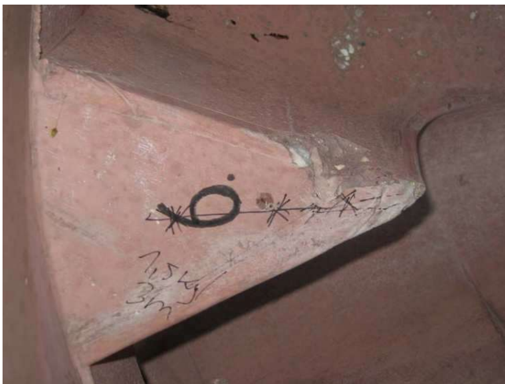
Immagine 27: pozzetto in cls SCC ad alta prestazione – 1,5 kg da 3,0 m
