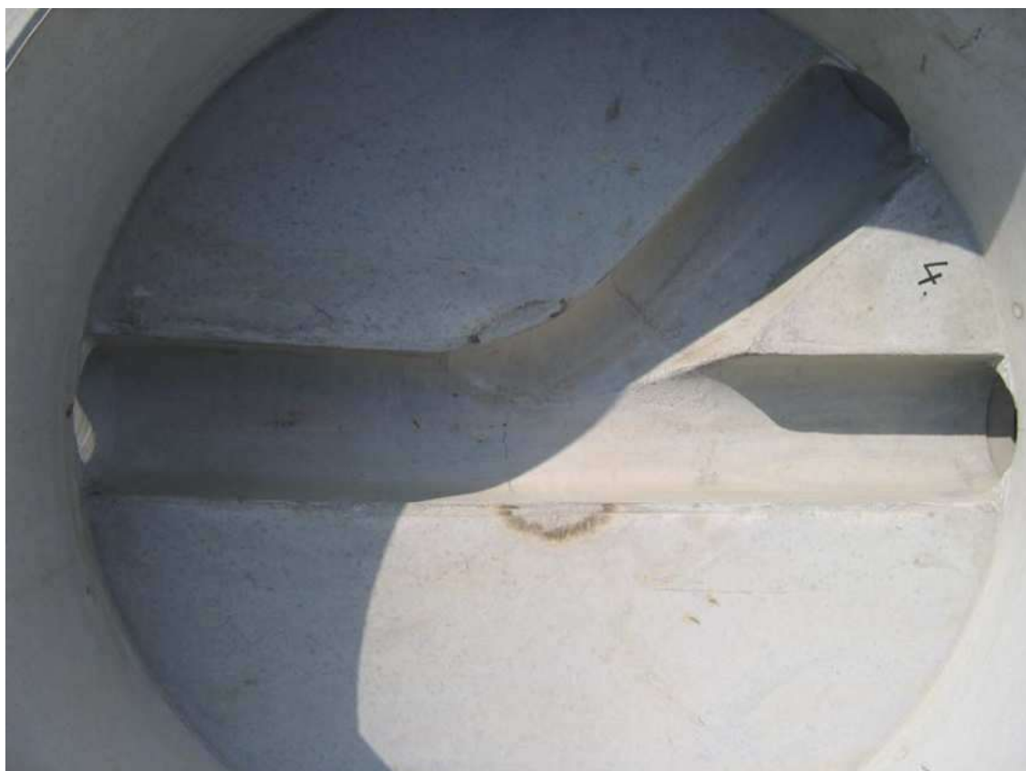
Immagine 4: campione di prova 4 / base pozzetto in SCC senza manicotti a tenuta
