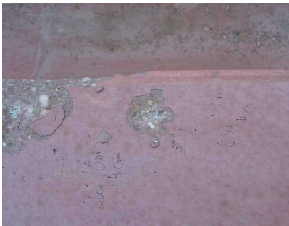
Immagine 26: pozzetto in cls ad alta prestazione – 6 kg da 3,0 m a 4 cm di distanza
