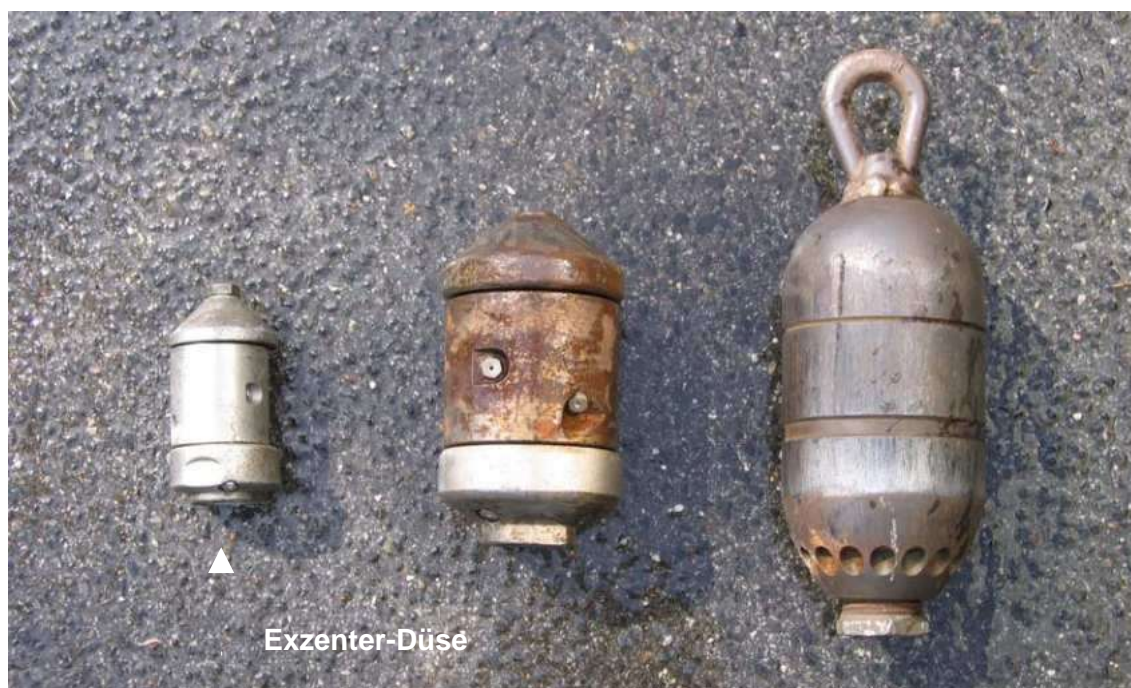
Immagine 29: teste di lavaggio ad alta pressione impiegate per lo svolgimento dei test
