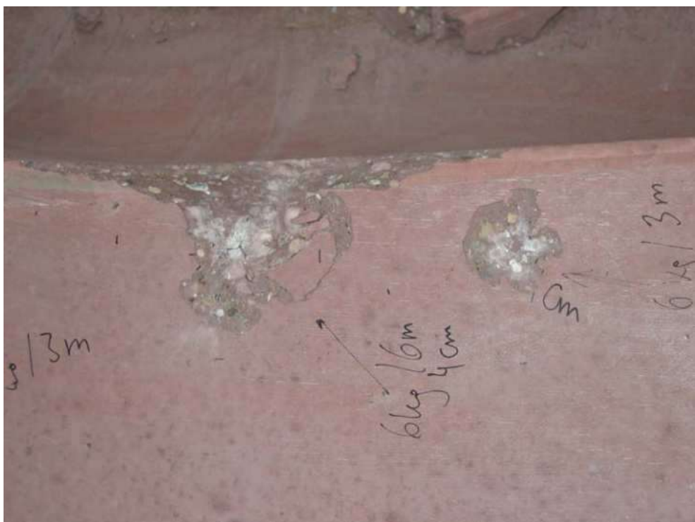
Immagine 28: pozzetto in cls SCC ad alta prestazione – 6,0 kg da 6,0 m
