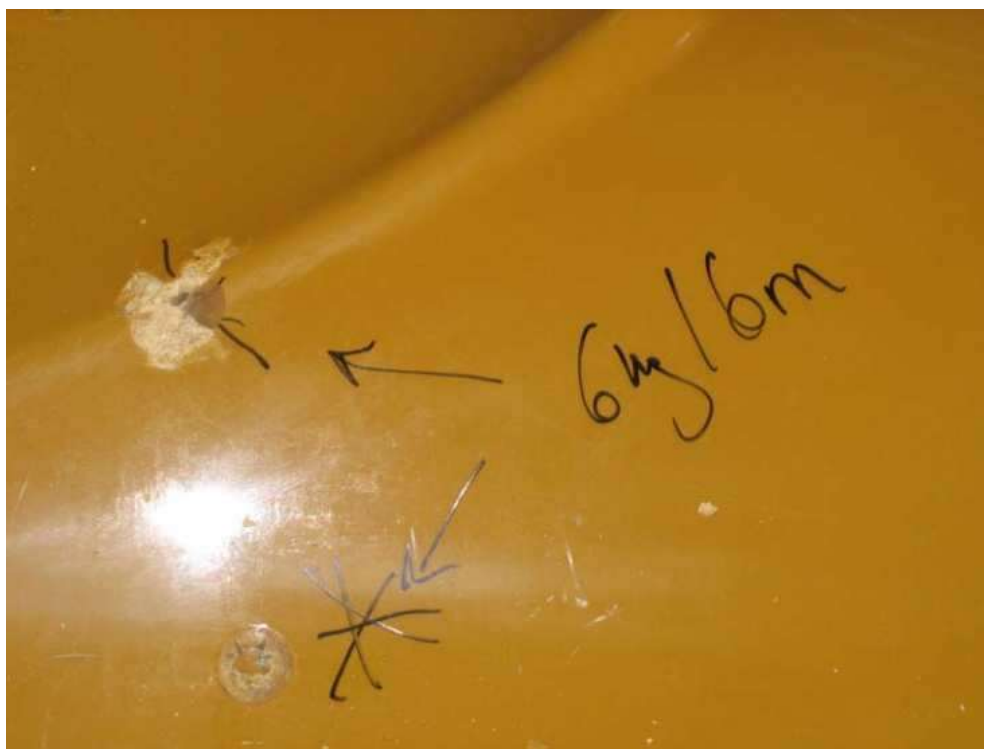
Immagine 17: 6,0 kg da altezza 6,0 m sulla base del canale e berma
