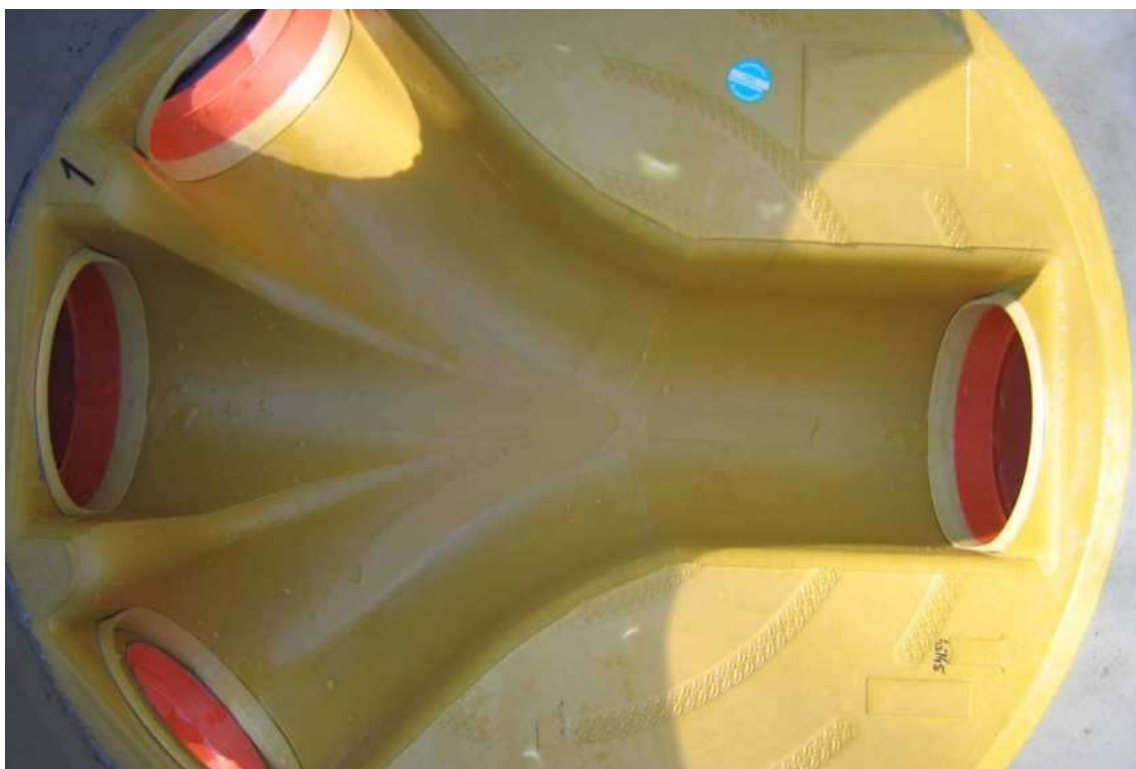
Immagine 45: pozzetto in PP DN 250 dopo 50 passaggi
